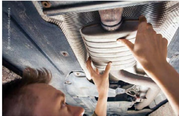
Pro Fahrzeug (Diesel und Benzin) werden in einem Abgaskatalysator etwa 5 Gramm Platin oder Palladium verbaut.
